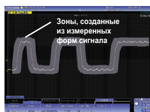
Поиск форм сигнала в зонах, созданных путем перемещения измеренных форм сигнала вверх/вниз/влево/вправо.
