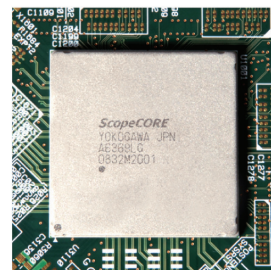
Интегральная схема быстрой обработки данных ScoreCORE
